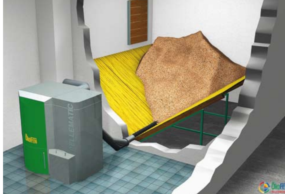
Schéma d'une chaufferie à granulés
